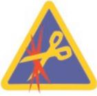
Risque de cisaillement, de coupure ou de sectionnement |
