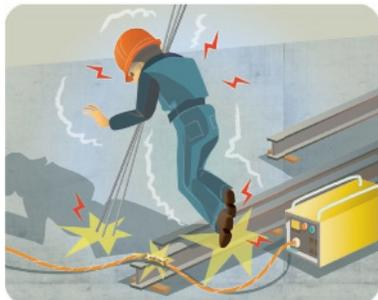
Contact entre le corps et des pièces nues normalement sous tension directement ou à l'aide d'un conducteur.
