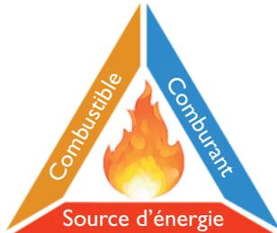
L'absence d'un des trois éléments empêche le démarrage de la combustion.
