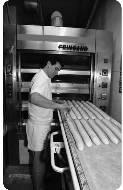
Hassen Nakouri dans son laboratoire pour le lamage (opération consistant à inciser le pain pour qu'il gonfle mieux à la cuisson).
